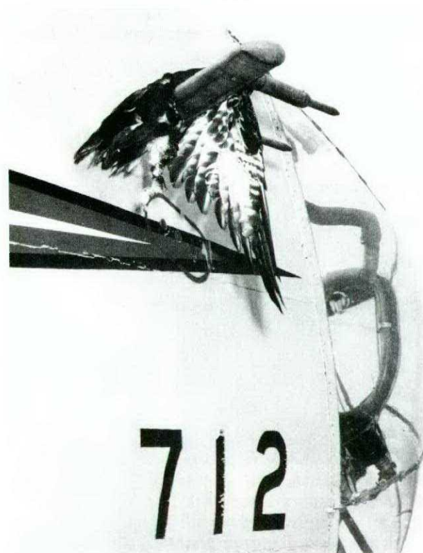
Argus — Birdstrike on nose on takeoff. Argus — Impact d'oiseau sur le nez, heurt survenu au décollage.
