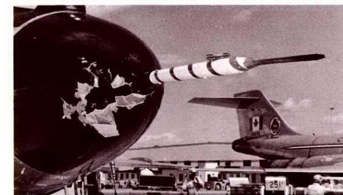
CF101 — Strike on nose. — Impact sur le nez.
