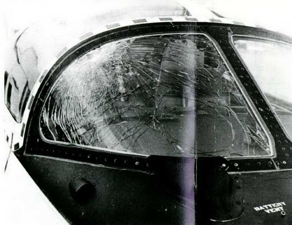
Tutor — Bird hit windshield at night. Pilot sprayed with glass but uninjured. — L'oiseau a heurté le pare-brise en pleine nuit. Le pilote n'a pas été blessé par les éclats de verre.
