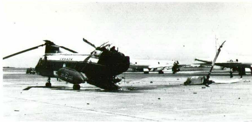
Labrador — Tail rotor struck ground on maintenance run-up. Le rotor de queue de ce Labrador a heurté le sol pendant un point fixe maintenance.
