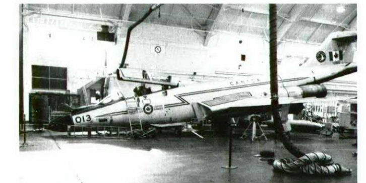
CF101 — Main gear tire blew (overpressure) — knocked nose off jack Le pneu du train principal de ce CF101 a éclaté (surpression) et le nez s'est désengagé du vérin.
