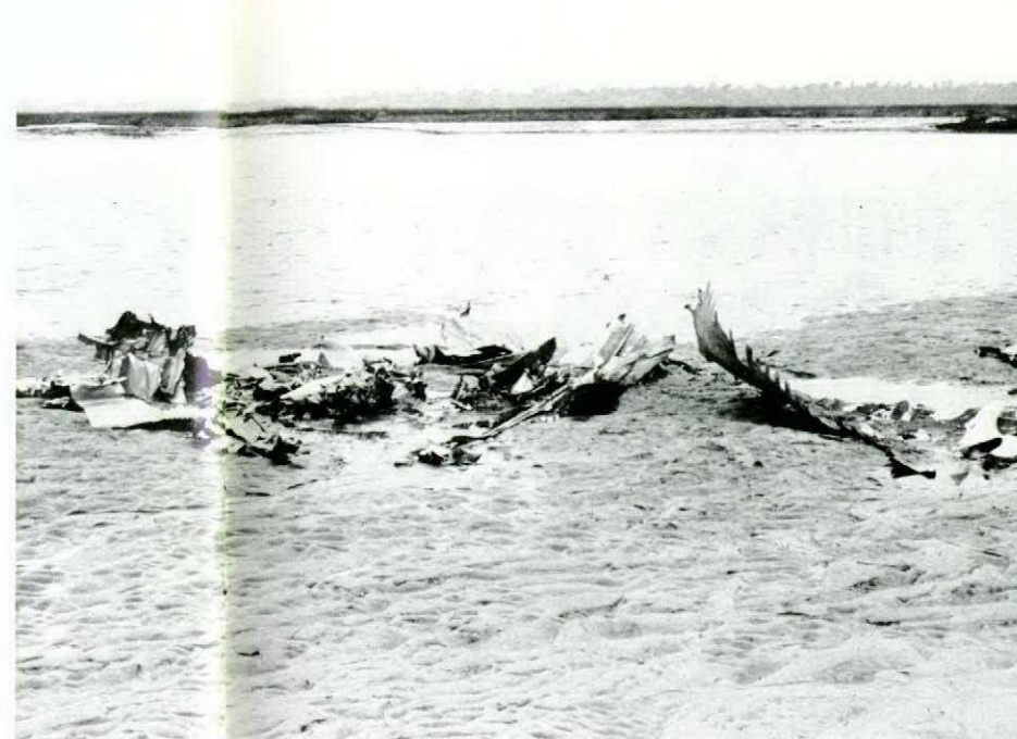
CF100 — lost control in severe turbulence — crew ejected CF100 — L'équipage in a perdu la maîtrise en très fortes turbulences — ils se sont éjectés.
