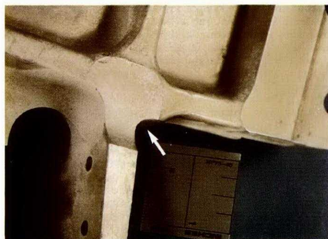
The critical radius (arrow) on the 7075-T6 aluminum tail fitting responsible for the Snowbird disaster. Le congé de raccordement critique (flèche) de la serrure de queue en aluminium 7075-T6 responsable de l'accident de Snowbird. (continued on page 20)
