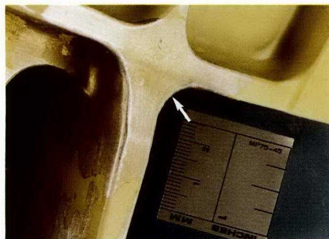
The redesigned critical radius (arrow) on the 4130 steel tail fitting. Le congé de raccordement critique (flèche) redessiné sur la serrure de queue en acier 4130. (suite à la page 21)
