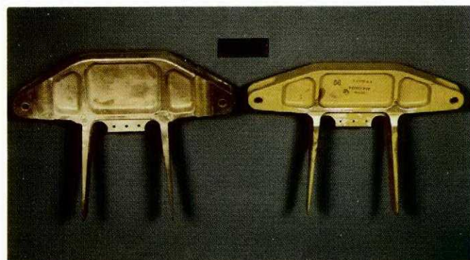
The 7075-T6 aluminum (left) and the 4130 steel (right) tail fittings shown as received. Les serrures de queue en aluminium 7075-T6 (à gauche) et en acier 4130 (à droite), telles qu'elles ont été reçues.
