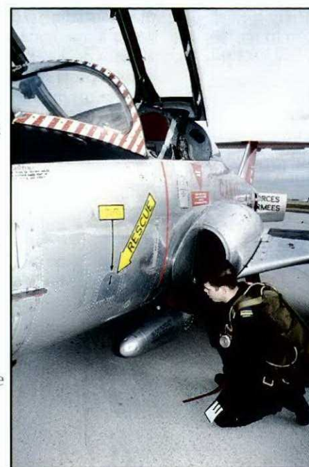
Lt Dirk Paquette, Central Flying School, demonstrates the correct method of checking a belly tank./Le Lt Dirk Paquette, Ecole centrale de vol, démontre la méthode appropriée de vérifier le réservoir central extérieur.
