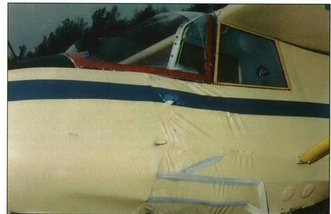
Left Hand Side Damage, Note Damaged Canopy. Dommages du côté gauche - notez les dommages à la verrière.
