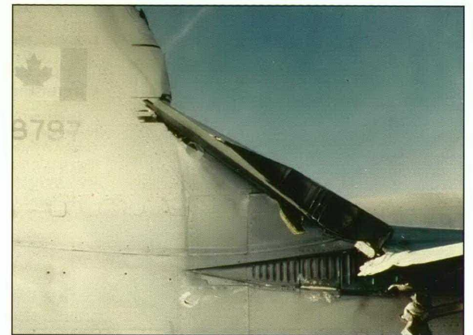
Outboard view RH TEF resting into RH V-stab. Vue extérieure du volet de bord de fuite droit encastré dans la dérive en V droite.
