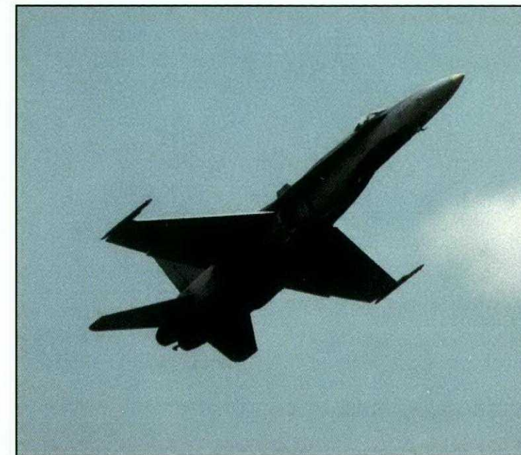
A CF18 at a slow and high angle of attack – 120 kts. / Un CF18, lent et à un angle d'attaque élevé – 120 noeuds.
