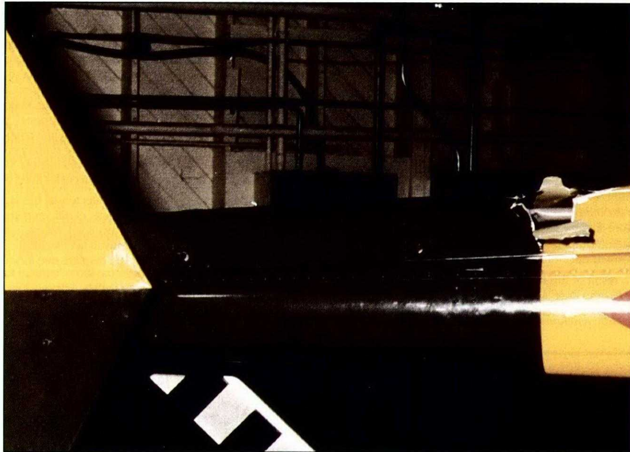
Damage to the tail boom above the red arrow. / Dompage au mât de queue au-dessus de la flèche rouge.
