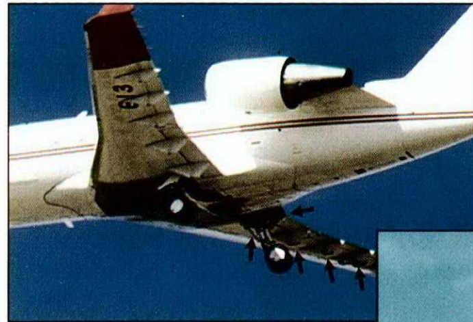
Aircraft on first pass showing damage to right wing and landing gear. / Avion durant la première passe, montrant les dommages à l'aile droite et le train d'atterrissage.
