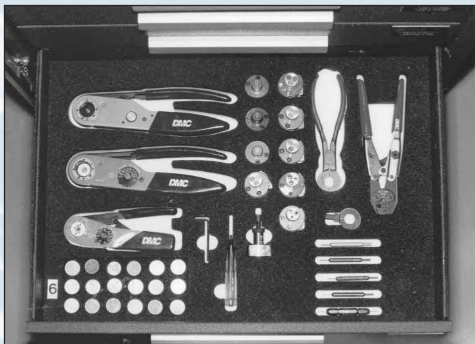
Trousse à outils du kit électrique de CF-18.
