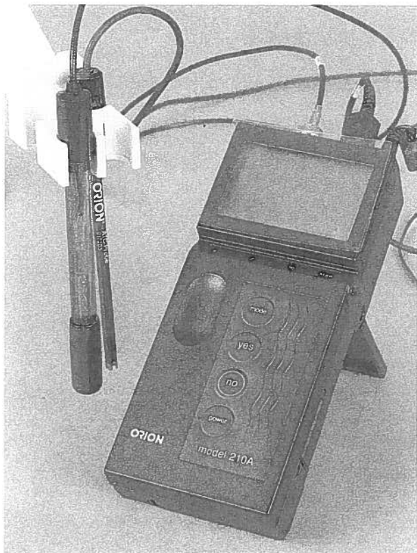
Figure 2. pH-mètre portable Orion et électrode combinée remplie d'un gel pour la mesure du pH de solutions de traitement et de l'eau de lavage.
