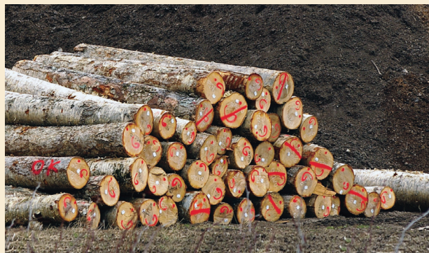
Billes de bouleaux jaunes marquées et étiquetées pour mieux repérer celles de meilleure qualité tout au long du processus, soit de la forêt à la scierie au produit.
