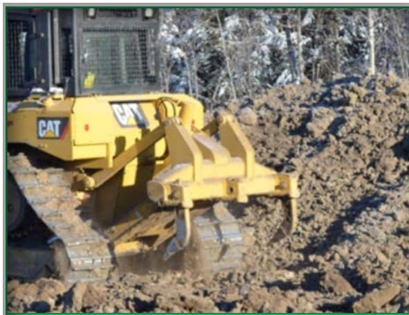
Figure 4a. Dents de défonceuses fixées aux extrémités de la barre multifonction du bulldozer
