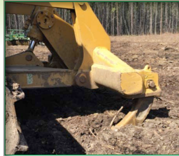
Figure 4b. Dents de défonceuses fixées aux extrémités de la barre multifonction du bulldozer
