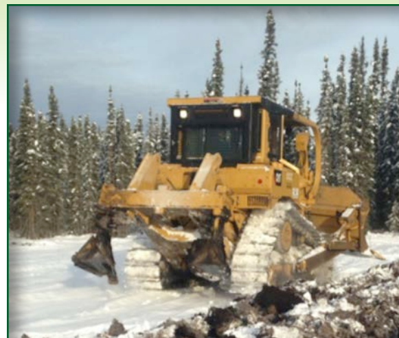
Figure 1a. Une sous-soleuse à ailerons fixée aux extrémités de la barre multifonction du bulldozer
