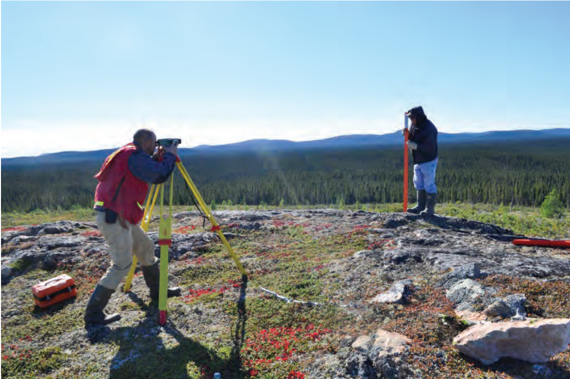
Figure 5. Arpentage du sommet dans le cadre de l'établissement de la limite entre la réserve de parc et une parcelle des terres des Inuits du Labrador
