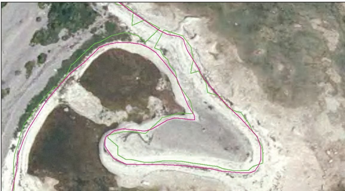
Figure 4. Différences entre le tracé tiré de la technique LIDAR (vert) et les interprétations obtenues par photogrammétrie (rose) concernant la limite de l'eau
