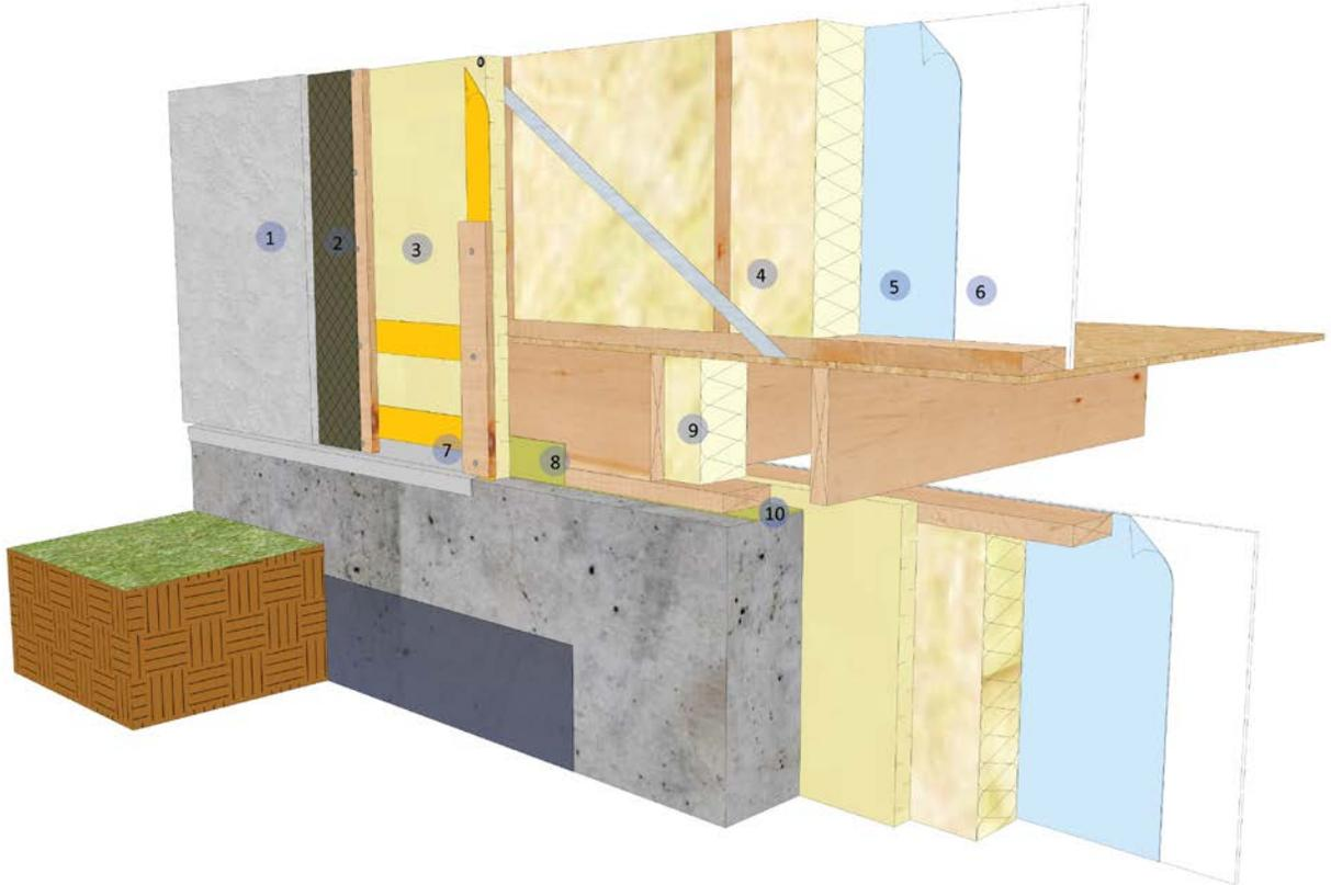
Figure 12 : Illustration du point de transition d'un mur sous le niveau du sol à un mur au-dessus du niveau du sol, en utilisant de l'isolant à l'extérieur. Référence photographique: Ressources naturel Canada
