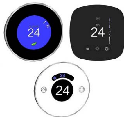
Figure 6-2 : Les thermostats intelligents adaptent automatiquement les paramètres de température afin d'améliorer le confort et réduire la consommation énergétique
