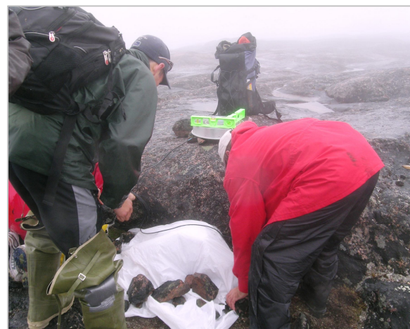
Station GPS prête pour l'acquisition de données brutes, qui seront traitées ultérieurement par la Division des Levés géodésiques.
