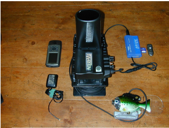
Équipement de video caméra sous marine utilisé pour observer la conduite d'entrée d'eau du T-Lake .
