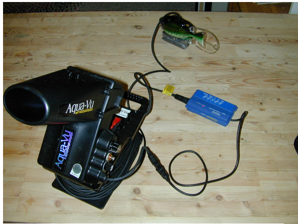
Équipement de video caméra sous marine utilisé pour observer la conduite d'entrée d'eau du T-Lake .
