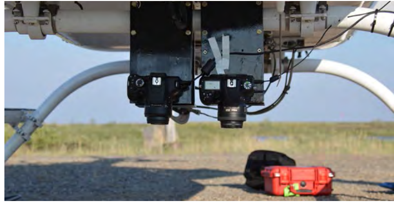
Des caméras sont fixées à un hélicoptère afin de prendre des photographies aériennes à haute résolution dans la région du Mackenzie Delta.
