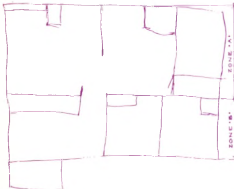
Figure 6. «Exemple de distorsion graphique».—Dessin type illustrant l'exagération de la superficie de la zone «A» par rapport à celle de la zone «B».
