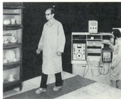
Essais sur maquette à l'échelle grandeur. Photo du haut: épreuve dont le but est de déterminer le fléchissement du plancher sous l'action d'un poids concentré. Photo du bas: essai de vibration.
