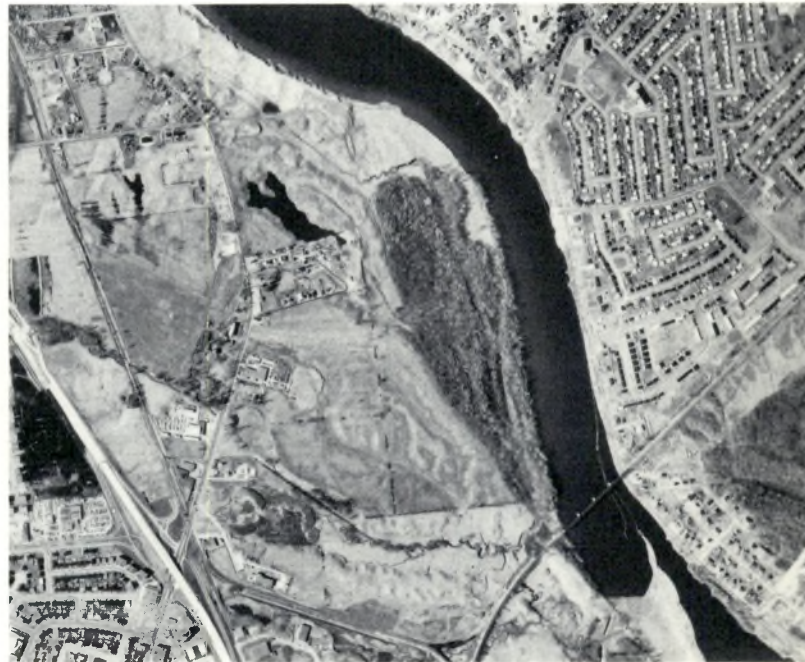
5 Un zonage biophysique détaillé permet de délimiter les zones exposées aux glissements de terrain au nord de la ville de Hull; d'épaisses couches d'argile sensible imposent un développement urbain et routier très soigné; sur la rive est de la rivière Gatineau, plusieurs zones basses sont exposées aux inondations printanières.
