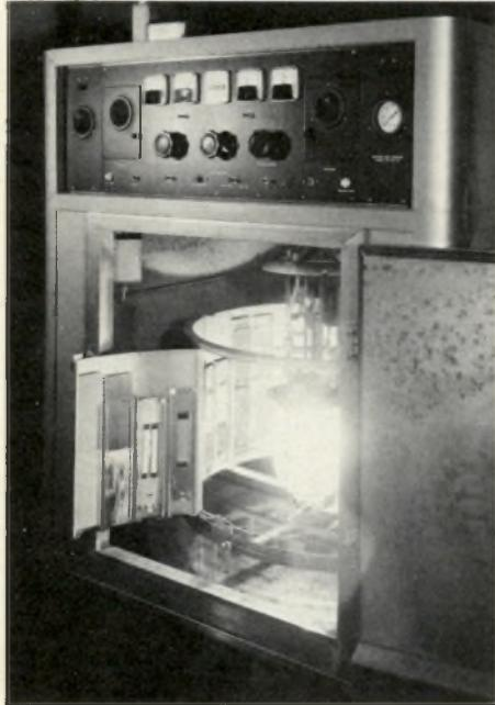
Simulateur d'intempéries, à la Division des recherches sur le bâtiment du C.N.R.
