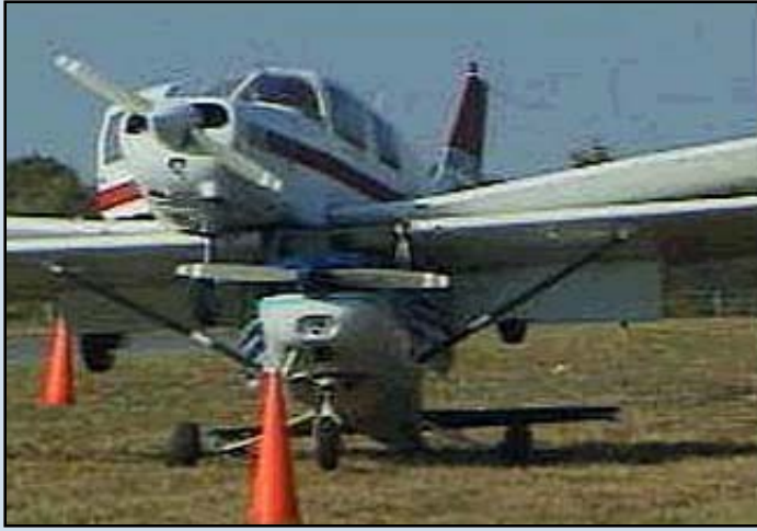
Exemple classique d'un conflit de visibilité entre les aéronefs à voilure haute et les aéronefs à voilure basse de l'aviation générale. Abordage incroyable à l'aéroport municipal de Plant City, en Floride, le 11 décembre 1999.
