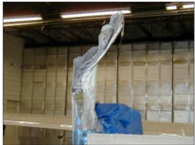
Vue de près des dommages de la gouverne de direction de gauche du Cessna 337.
