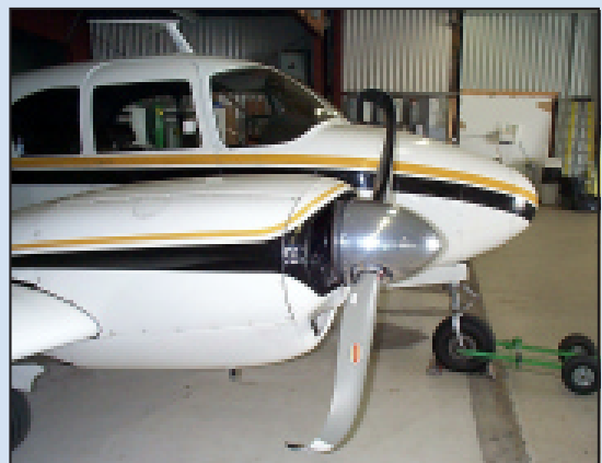
Les hélices après l'accident, irréparables.
