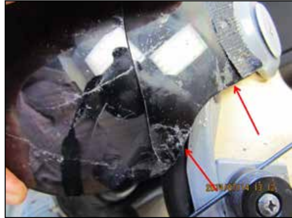
Photo 4 Gros plan du côté gauche de la visière du casque du pilote montrant les dommages causés par l'impact (Source : Héli-Boréal)
