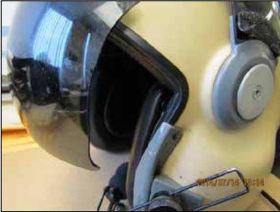
Photo 3. Casque du pilote montrant les dommages au côté gauche de la visière causés par l'impact (Source : Héli-Boréal)
