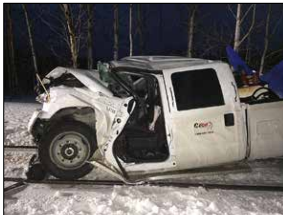
Figure 3. Vue du côté du véhicule rail-route après la collision
