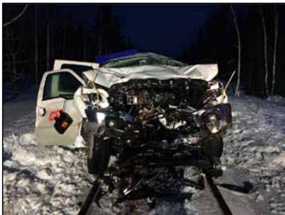
Figure 2. Vue de l'avant du véhicule rail-route après la collision
