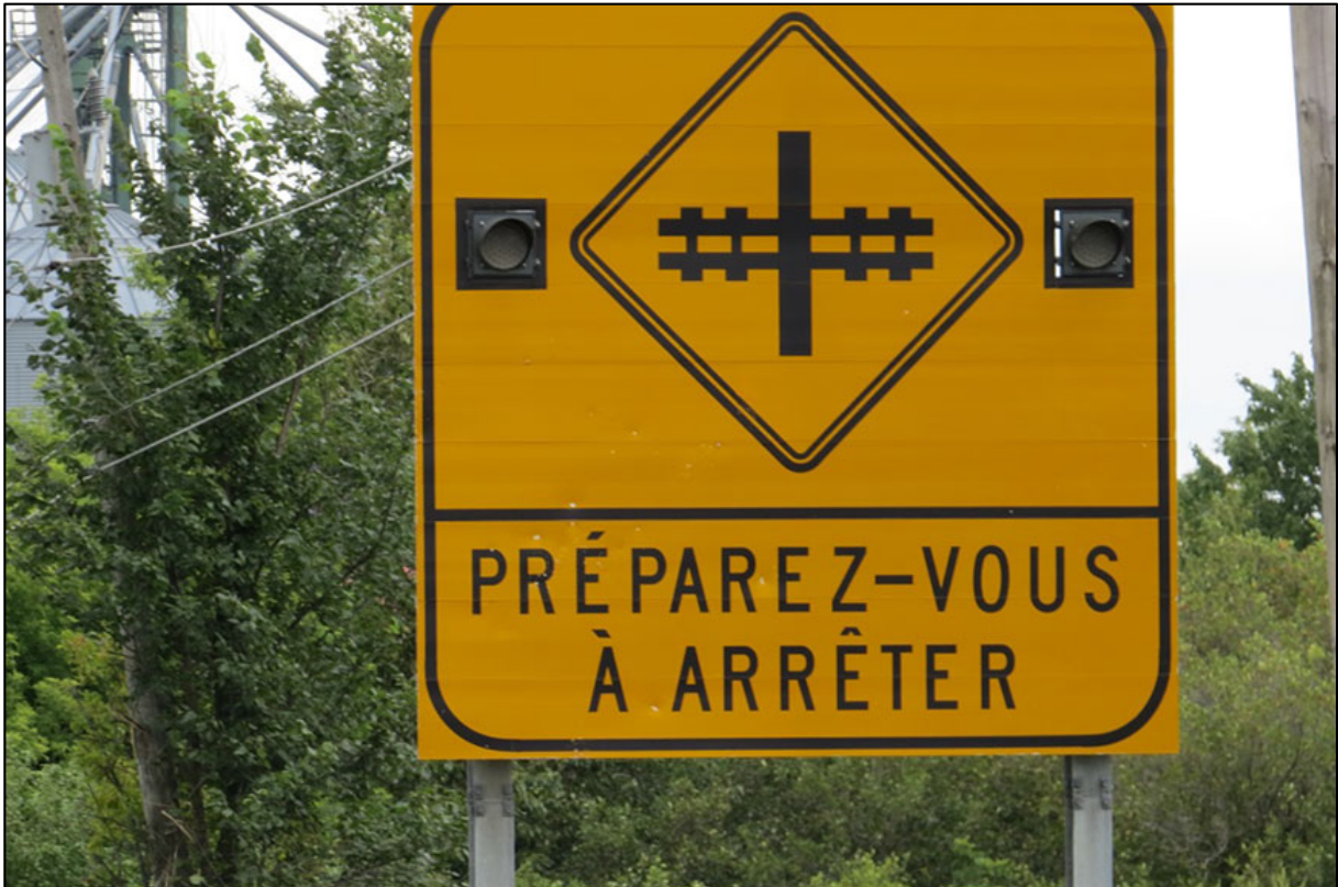
Figure 9. Panneau « Préparez-vous à arrêter » avec feux clignotants sur la route 347 à Saint-Norbert (Québec)
