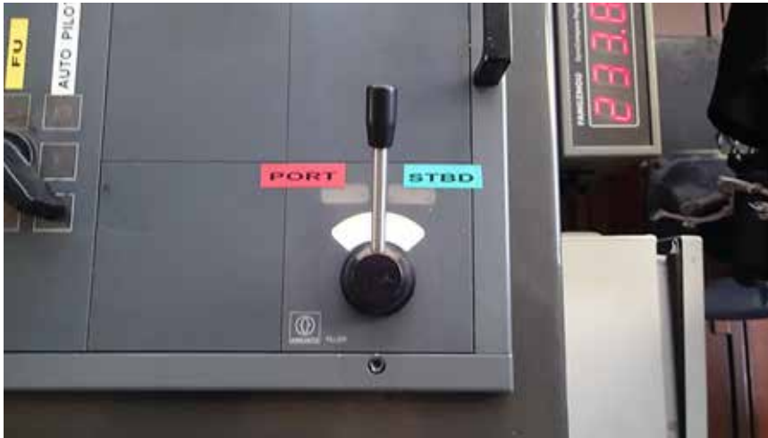
Figure 9. Commande de barre non asservie du MSC Monica sans le disque de plastique, mais avec de nouvelles étiquettes de couleur
