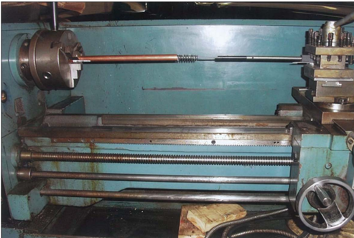
Figure 1 : Tour utilisé pour nettoyer l'intérieur des tubes de zirconium contaminés par de l'uranium naturel
