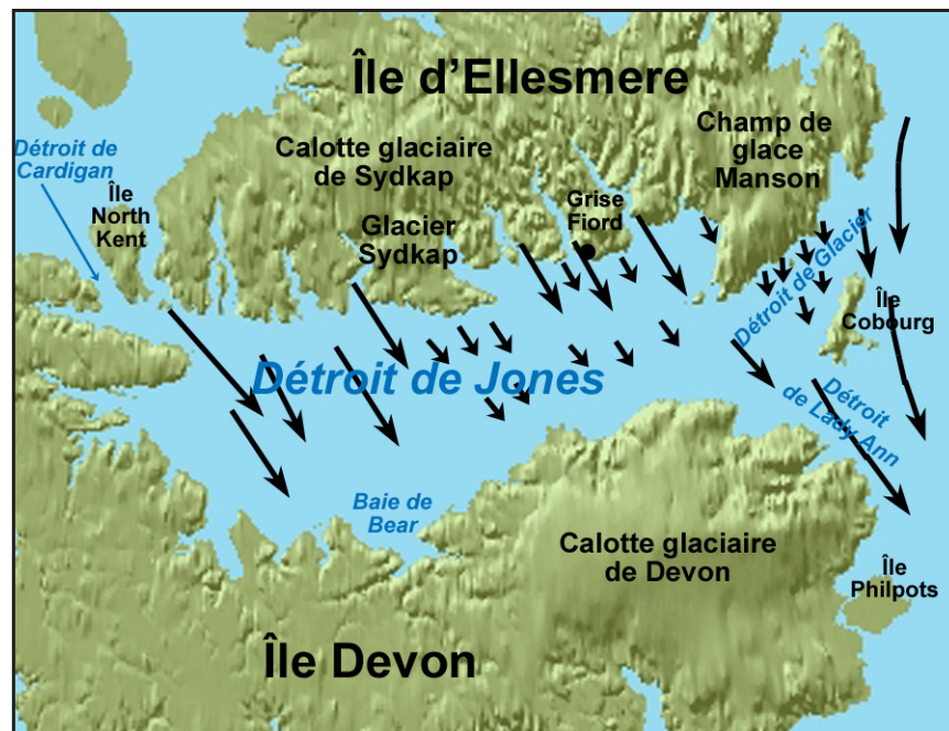
Figure 29 : Vents liés à une circulation du nord selon de multiples images RADARSAT. La longueur des flèches indique la vitesse relative du vent dans chaque région.
