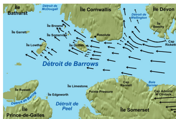
Figure 59 : Compilation de multiples images montrant les vents lors d'une circulation de l'est et la protection offerte par le côté sous le vent des îles Griffith, Lowther et Prince Leopold. La longueur des flèches indique la vitesse relative des vents dans chaque région.
