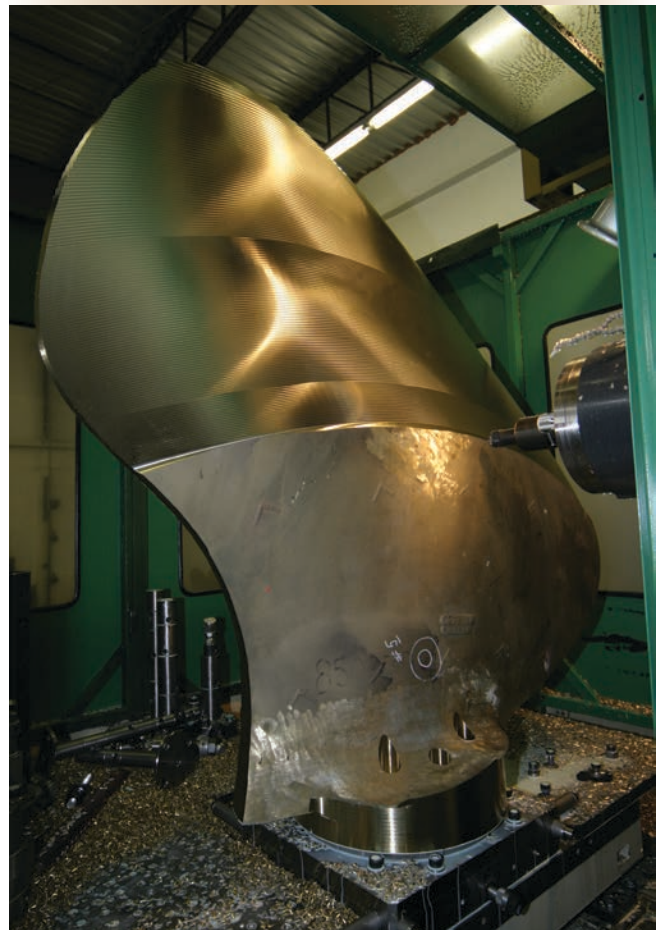
Figure 10 : Usinage de pales d'hélices
