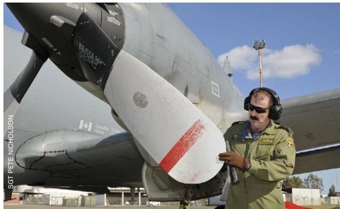
L'officier mécanicien de bord, l'Adj David Pawulski, inspecte une hélice sur un CP-140 au cours d'une inspection pré-vol durant l'exercice *Proud Manta*.
