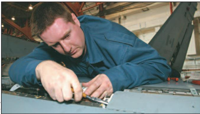
Le Sdt John Bush, technicien en systèmes aéronautiques du 409<sup>e</sup> Escadron d'appui tactique de la 4<sup>e</sup> Escadre Cold Lake, installe une goupille fendue dans la transmission de l'ensemble de bord d'attaque d'un CF-18 Hornet dans le cadre d'une inspection périodique.
