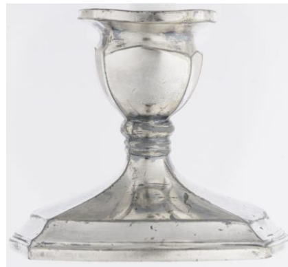
© Gouvernement du Canada, Institut canadien de conservation. ICC 120260-0316 Figure 12 : Chandelier en plomb plaqué argent. Le métal gris mat, visible aux endroits où le placage a été retiré par polissage, a donné un résultat positif lors du test de détection du plomb.
