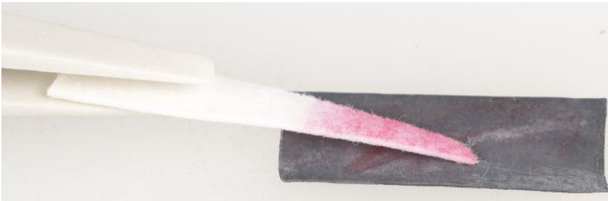
© Gouvernement du Canada, Institut canadien de conservation. ICC 120260-0223 Figure 5 : Papier réactif Plumbtesmo, après que la réaction s'est produite et que le papier a viré au rose.
