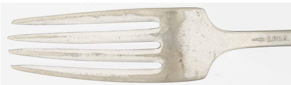
© Gouvernement du Canada, Institut canadien de conservation. ICC 120260-0354 Figure 8 : Fourchette en maillechort, électroplaquée avec de l'argent. Le test de détection du cuivre a donné un résultat positif aux endroits où le placage a disparu.
