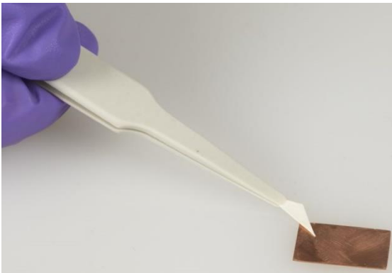
© Gouvernement du Canada, Institut canadien de conservation. ICC 120260-0229 Figure 3 : Un papier réactif Cuprotesmo mouillé avec de l'eau pure est tenu avec des pincettes en plastique et mis en contact avec un morceau de cuivre.
