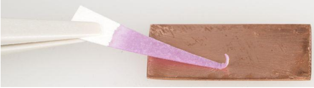
© Gouvernement du Canada, Institut canadien de conservation. ICC 120260-0231 Figure 4 : Papier réactif Cuprotesmo, après que la réaction s'est produite et que le papier a viré au rose.
