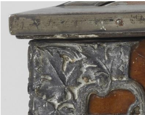
© Gouvernement du Canada, Institut canadien de conservation. ICC 126182-0053 Figure 4. Détails des résidus de polissage blancs accumulés, en raison d'un rinçage insuffisant, dans les creux d'ornements en argent sterling apposés sur un coffret en bois.
