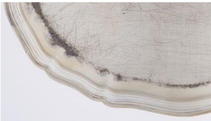
© Gouvernement du Canada, Institut canadien de conservation. ICC 120260-0331 Figure 11. Un plateau plaqué argent et verni. Le placage est terni dans les zones endommagées du revêtement, par exemple les égratignures et le pourtour.
