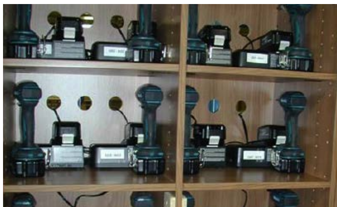
Remplacement des perceuses pneumatiques : Station de recharge pour les outils sans fil qui ont remplacé les perceuses pneumatiques. Économies annuelles estimées : 36 832 kWh ou 5 893 $.
