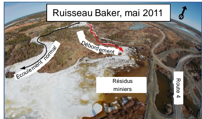
Formation d'aufeis en hiver dans le ruisseau Baker, près de Yellowknife (T.N.O.), qui empiète sur des résidus miniers et les remblais de la route. Photo prise par P. Vescie.
