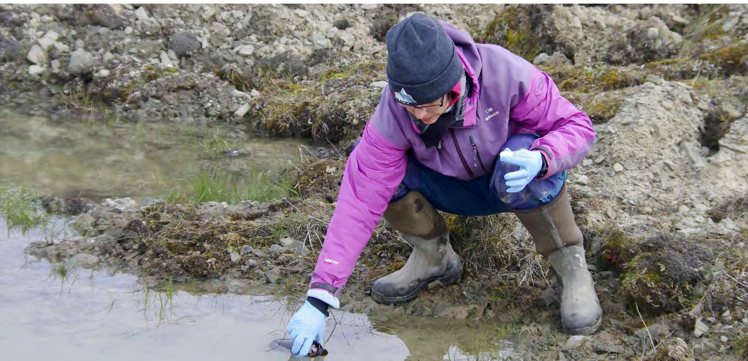
Prélèvement d'échantillons d'eau dans un bassin créé par le glissement de la couche active par détachement afin de procéder à la caractérisation moléculaire, et à la datation de la matière organique dissoute.
