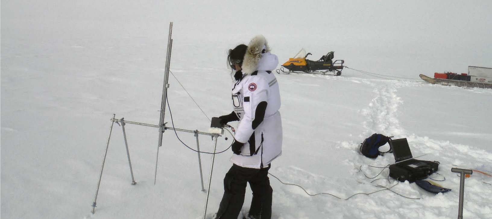
Mesure des flux lumineux dans la neige sur Ward Hunt Island afin de calculer le bilan énergétique détaillé à la surface.
