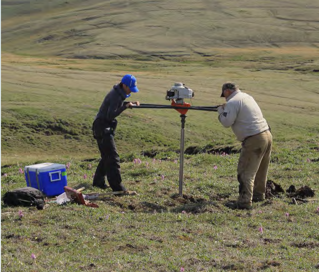
Prélèvement de carottes dans le pergélisol près d'un site de glissement de terrain important dans le parc national du Canada Aulavik, sur Banks Island, dans les Territoires du Nord-Ouest.
