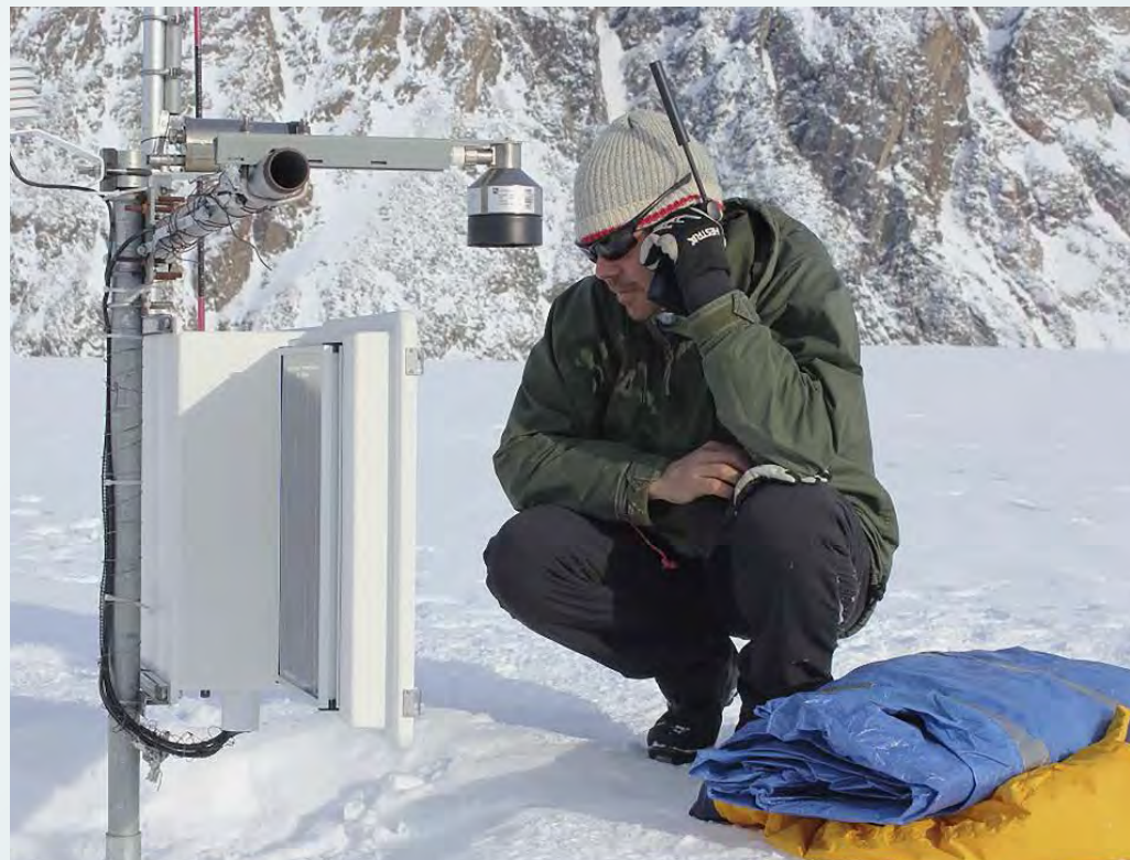
Établissement du diagnostic de défaillance de la station météorologique automatique du Sverdrup Glacier, sur Devon Island, au Nunavut.
