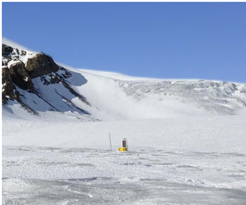
Une station GPS à deux fréquences à 870 mètres au-dessus du niveau de la mer à White Glacier où l'on a observé la vitesse des glaces à environ 10 centimètres par jour.
