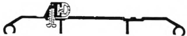
Selle avec butée et garniture rajoutées et dessus cannelé. Vérifier les finis, les largeurs et les hauteurs disponibles. J12120 J32120
