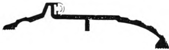
Seuil bloquant/feuilluré décalé avec garniture et dessus cannelé. Vérifier les finis, les largeurs et les hauteurs disponibles. J16180 J36180
