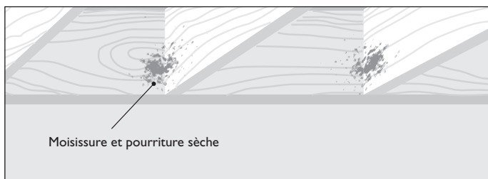
Figure 11 Pourriture et détérioration des solives de rive, des solives et des lisses d'assise en bois
