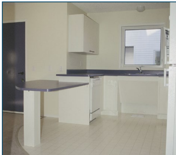
Figure 3 : Habitation accessible avec comptoirs de cuisine à deux niveaux Photo : Ron Wickman
