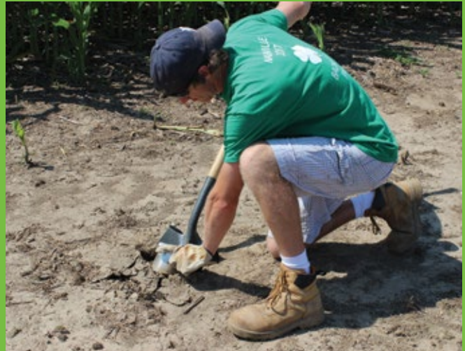
Prélèvement de carottes de sol pour déterminer les capacités d'air et de rétention d'eau utilisable par les plantes.
