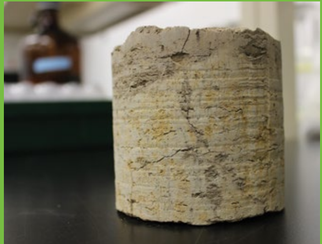
Carotte de loam argileux qui présente des signes d'engorgement périodique (taches grises et brunes).
