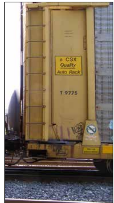
Figure 2. Exemple de l'emplacement d'une échelle sur le côté d'un wagon
