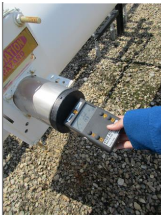
Figure 8 : Vérification du débit de dose d'une jauge fixe durant une inspection (Source : CCSN)
