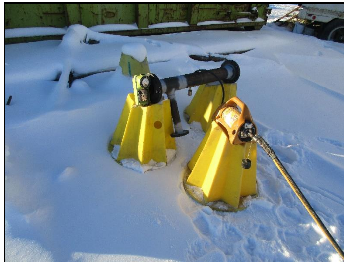
Figure 29 : Appareil d'exposition utilisé pour l'essai de matériaux (Source : CCSN)
