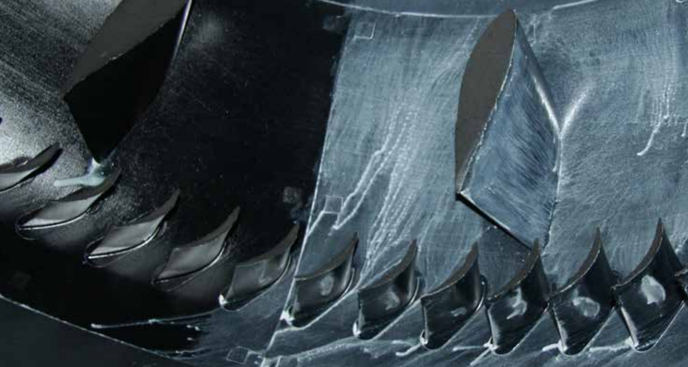
Essais agressifs sur des conduites reliant des turbines dans l'installation banc d'essai de turbine subsonique .
