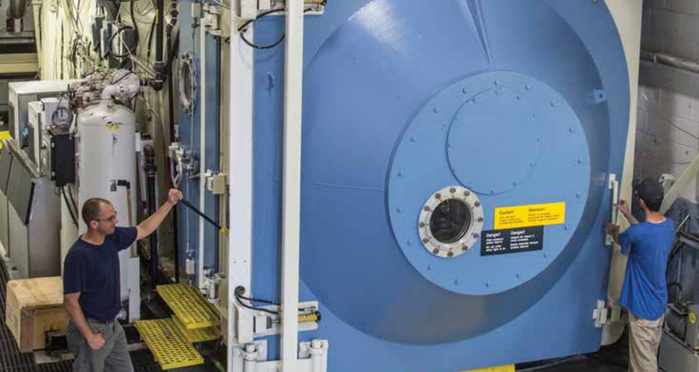
L'installation d'essai en altitude du CNRC peut évaluer les moteurs et les composants dans des conditions de fonctionnement en altitude simulées en brûlant divers carburants aviation.
