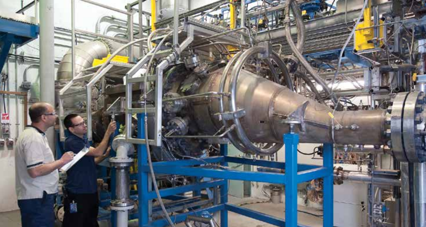
Une des cellules d'essai pour turbines à gaz du CNRC équipée du banc d'essai d'un client.
