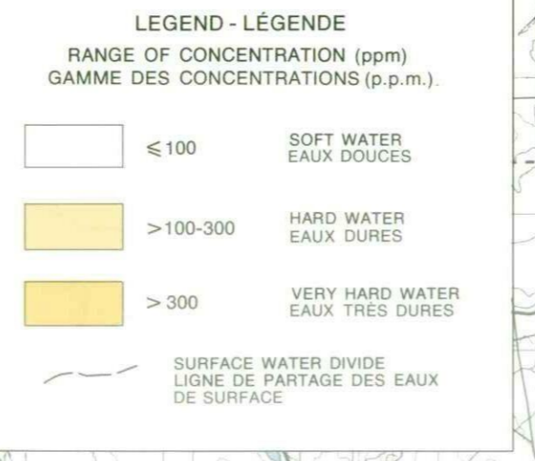
DISTRIBUTION OF GROUND WATER — FIGURE 13 — RÉPARTITION DE LA DURETÉ DES EAUX SOUTERRAINES (computer contoured) (carte à courbes de niveau, établie par ordinateur)
