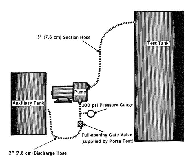
FIGURE 1 SCHEMATIC OF PUMP TEST RIG
