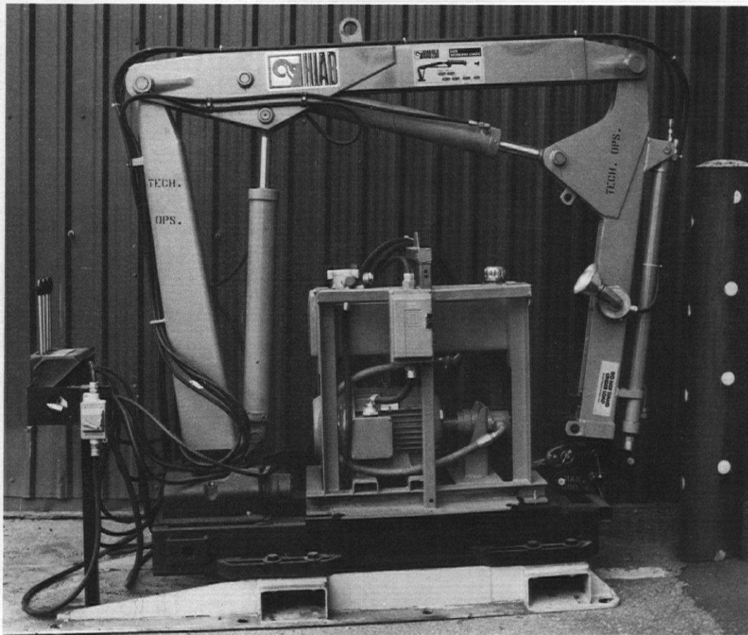
Crane for over-the-side work/Grue pour travaux par-dessus bord
