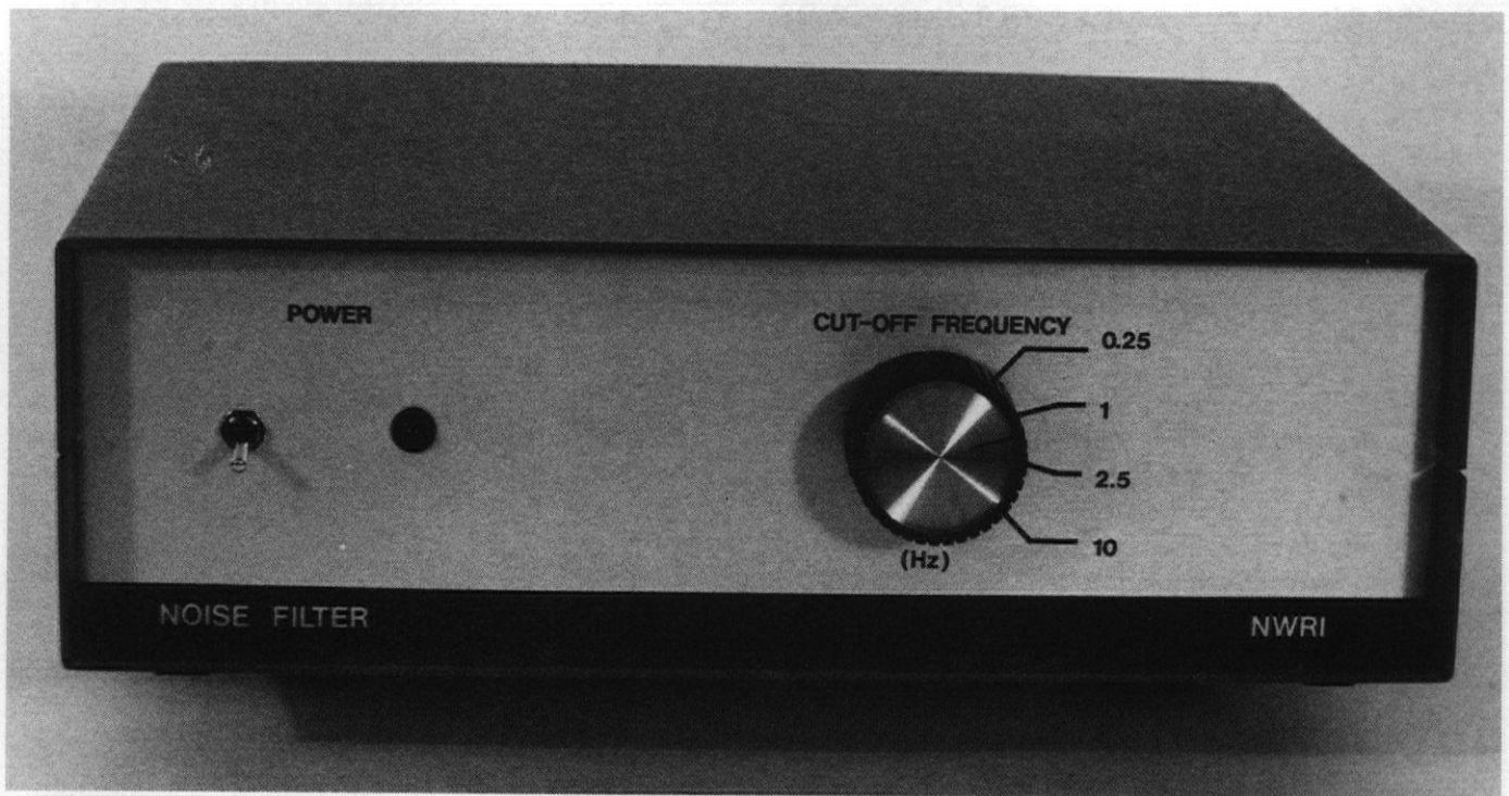
Electronic filter for removal of wave interferences/Filtre électronique pour éliminer les perturbations dues aux vagues
