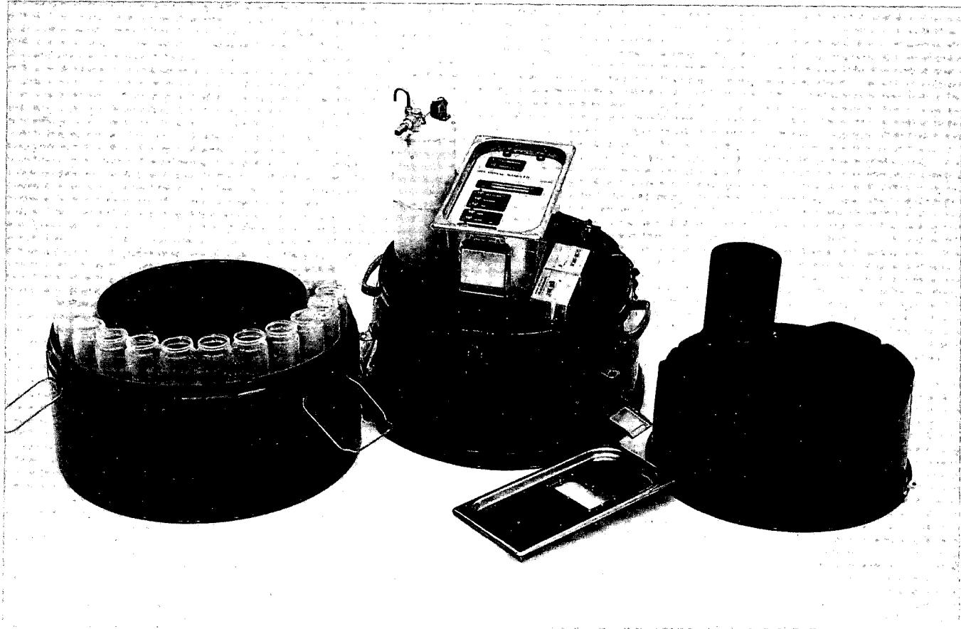
*Sectional sampler/Échantillonneur sectionnel*
