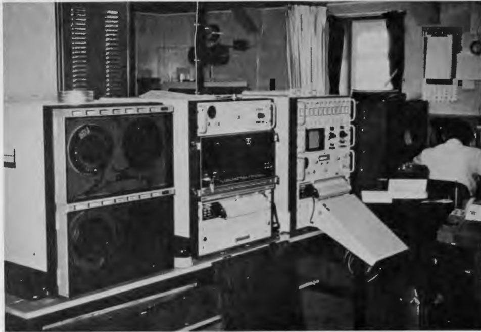
Équipement de réception et d'enregistrement des données de radiosondage utilisé pour l'Etga. Radiosonde receiving and recording equipment used during Gate.
