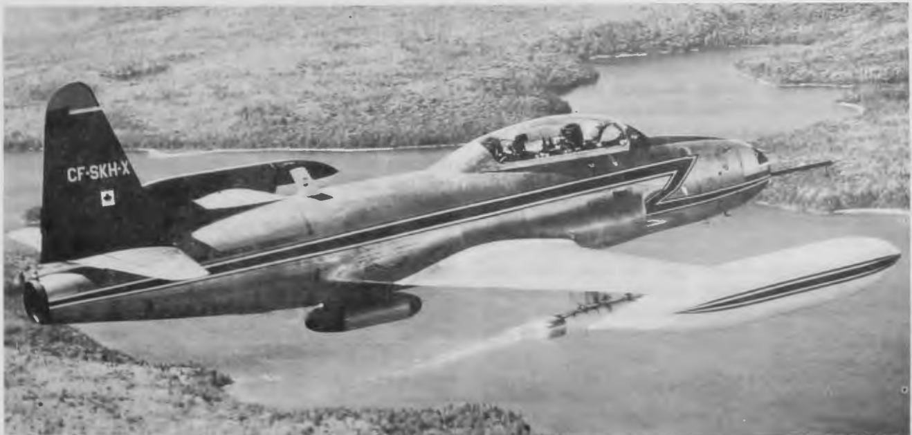
With silver iodide flares burning, the T-33 jet streaks over forest cover on a test flight mission. Lors d'une mission d'essai, le T-33 survole à vive allure une couverture forestière, des pièces d'artifice d'iodure d'argent brûlant sous ses ailes.
