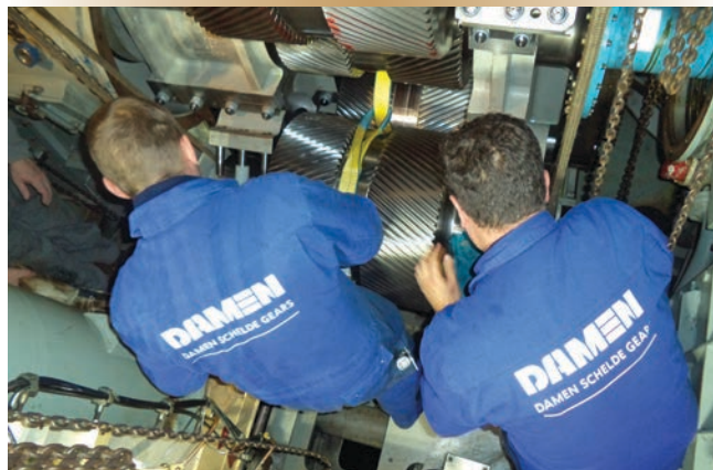
Figure 8. Engrenage baladeur inférieur remplacé dans la boîte de vitesses.
