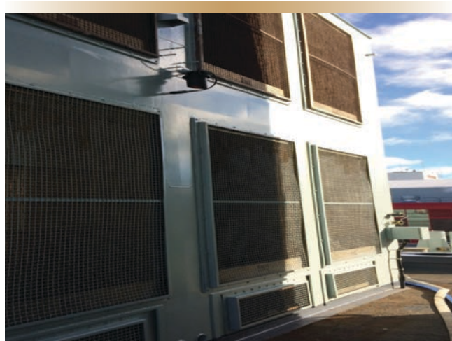
Figure 1. Les arrivées d'air de la turbine à gaz sur le pont supérieur d'une frégate de la classe Halifax .
