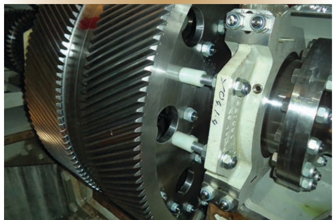
Figure 7. Roue d'engrenage dotée de freins temporaires (pièces de plastique blanc).
